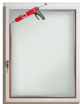
Lo spazio che rimane tra il vetro ed il telaio viene riempito su tutto il perimetro con colla sigillante.
